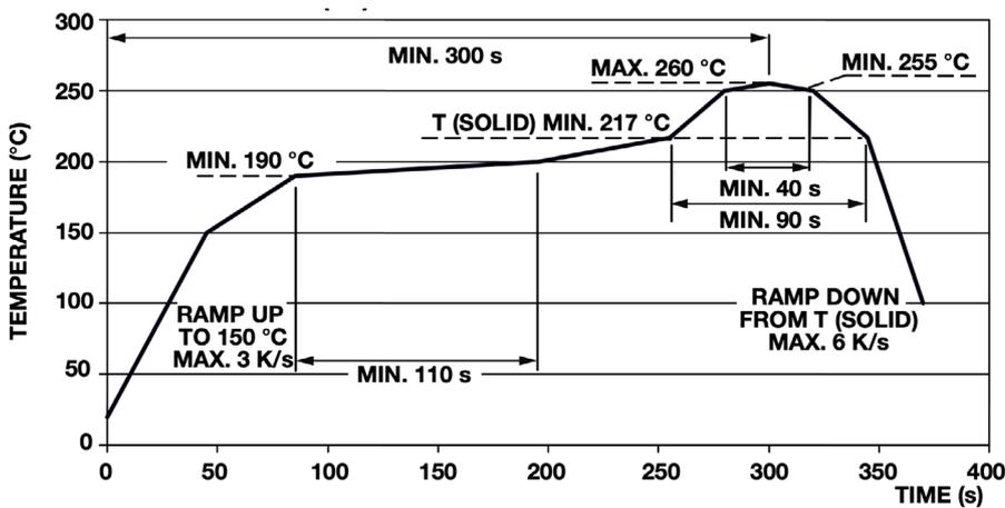
**SNPB REFLOW SOLDERING PROFILE**
